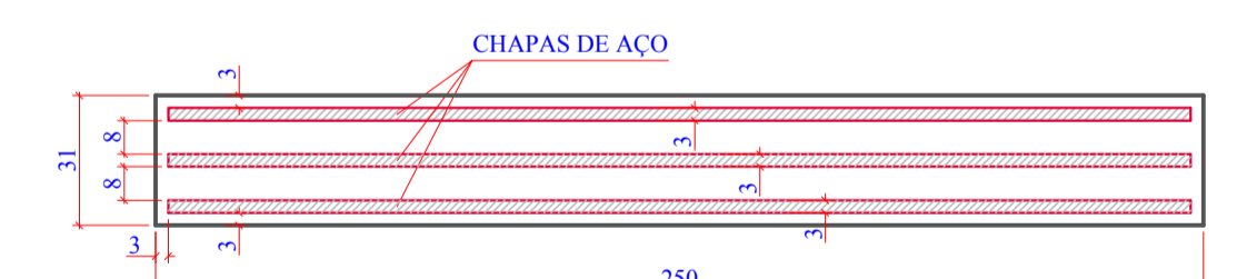
7 DETALHE APARELHOS DE APOIO: CORTE B-B ESCALA 1:2
