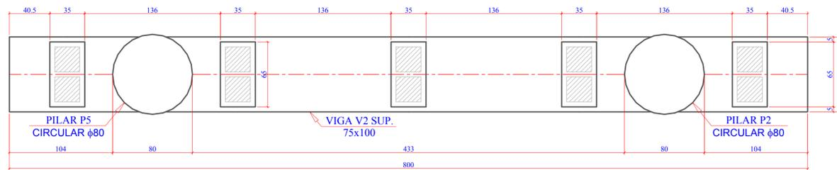
3 PLANTA DE FORMAS: PLANTA BAIXA PÓRTICO 02 NÍVEL 56,229m
