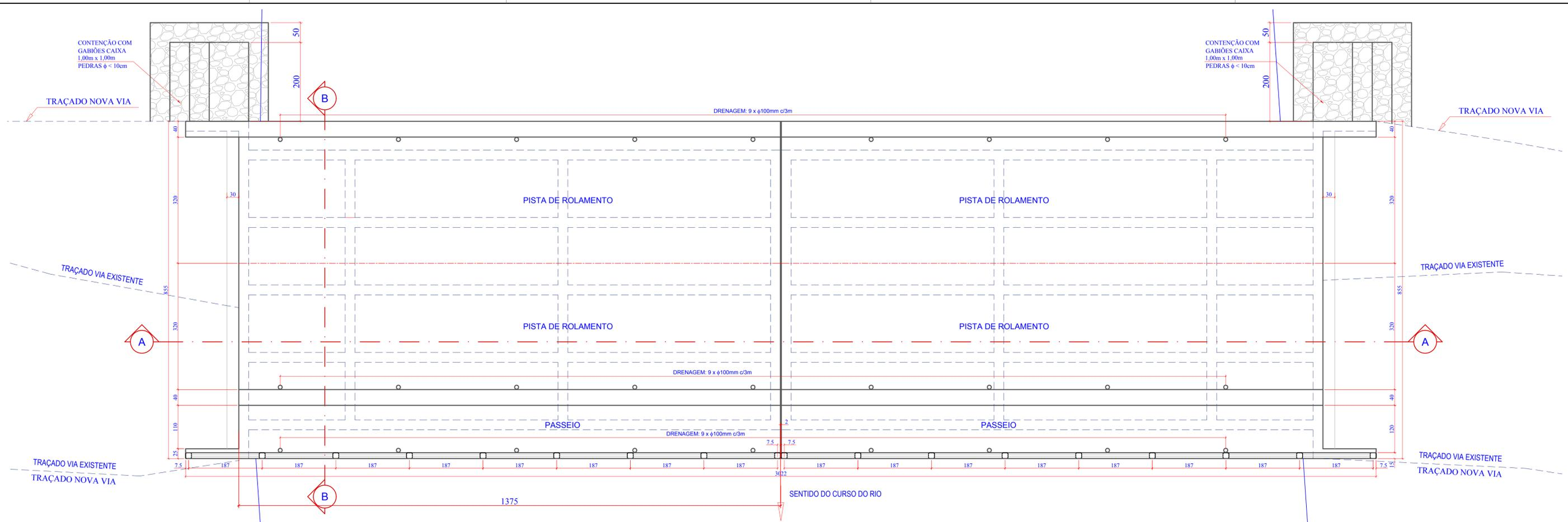
1 PLANTA DE FORMAS: PLANTA BAIXA LAJE DO TABULEIRO (NÍVEL 57,360m)
